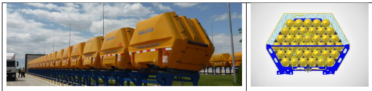
Figura 61 – Skids de armazenamento com capacidade nominal de 2.100m 3 cada a 250 bar (esquerda) e representação dos cilindros no interior de cada skid (direita). Fonte: Galileo
