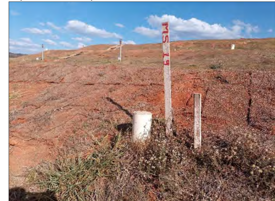
Marco Superficial Utilizado para o Monitoramento Geotécnico da Célula do Aterro
