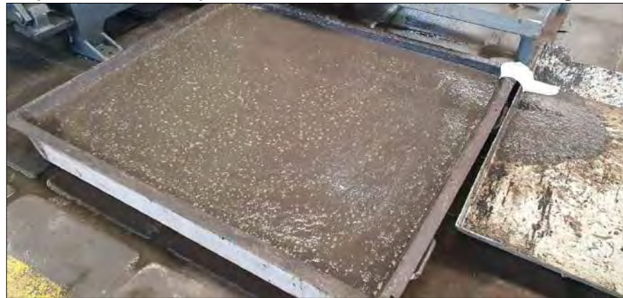
Material Orgânico Gerado após o Processo de Desidratação do Resíduo, o qual Será Enviado para o Processamento na Usina de Biodigestão
