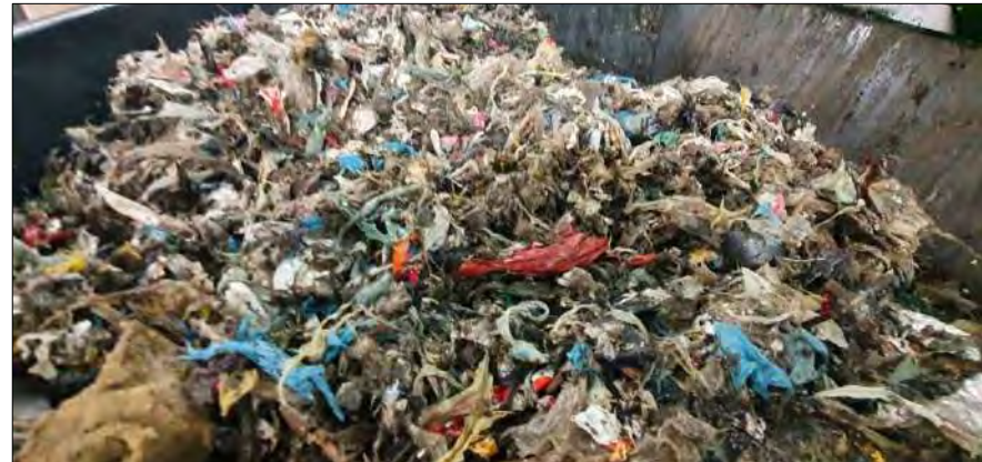
Material Inorgânico Gerado após o Processo de Desidratação do Resíduo, o qual Será Enviado para o Processamento na Usina de Tratamento Térmico
