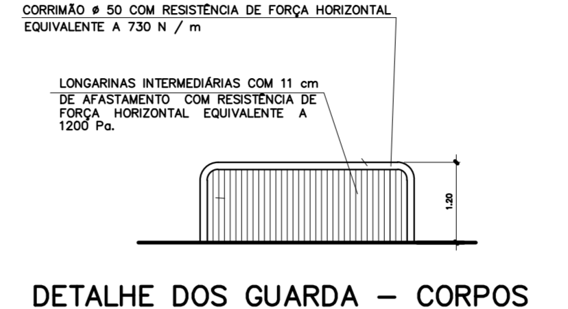
DETALHE DOS GUARDA-CORPO 3/2/20
